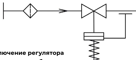
Схема подключение регулятора давления «после себя»
