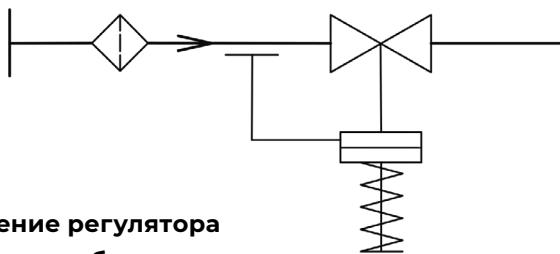
Схема подключение регулятора давления «до себя»
