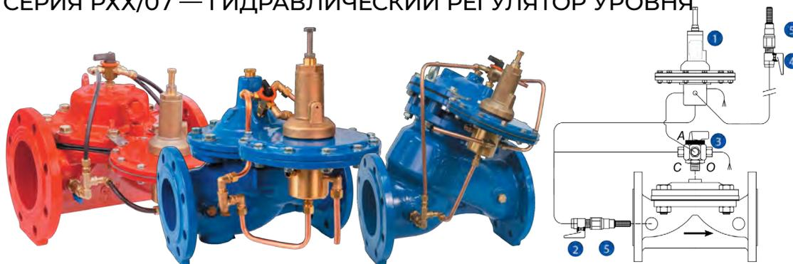
Клапан автоматически поддерживает постоянный уровень жидкости в резервуаре. Установка поплавка и длинные импульсные линии не требуются, пилотный регулятор прямого действия реагирует на отклонение статического давления в резервуаре. Возможно исполнение с двумя пилотами для поддержания крайних значений уровня жидкости (мин/макс). Время реагирования может быть отрегулировано для предотвращения гидроудара в момент закрытия клапана.
