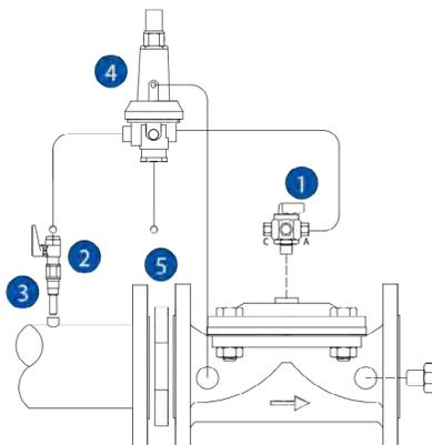
На входе в главный клапан устанавливается межфланцевая диафрагма, перепад давления на которой пропорционален расходу среды.
