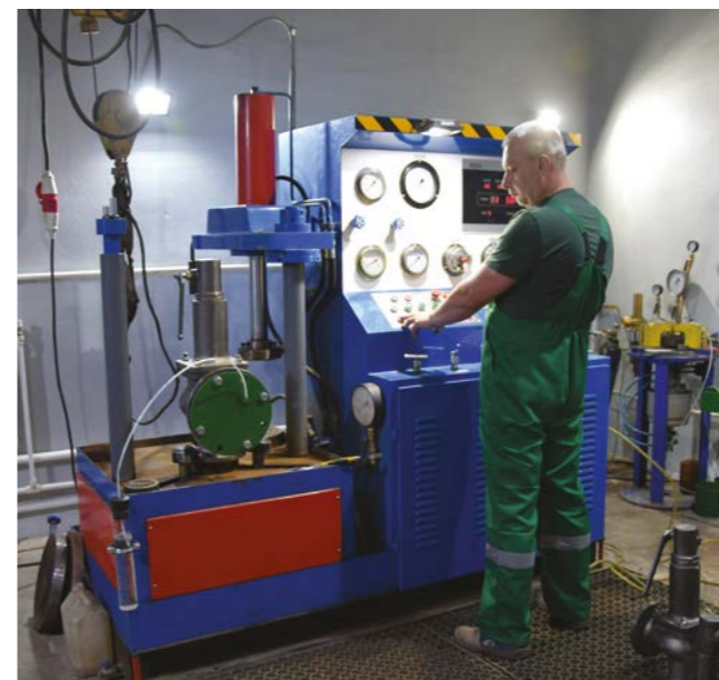
Фото 5. Тестирование и настройка давления срабатывания
