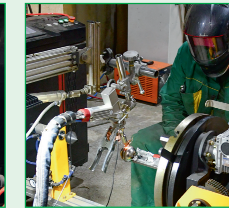
Сварка припайка конденсатоотводчика
