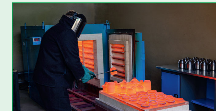
Муфельная печь для закалки внутренних деталей
