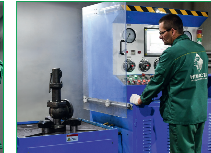
Испытательный стенд для настройки и тестирования предохранительных клапанов
