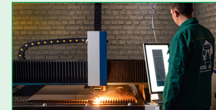
Оптоволоконный лазерный станок для резки металла
