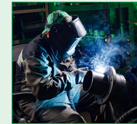
Круговая сварка сепаратора
