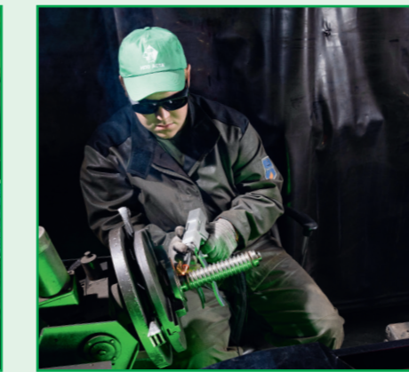
Сварка силифона регулятора давления
