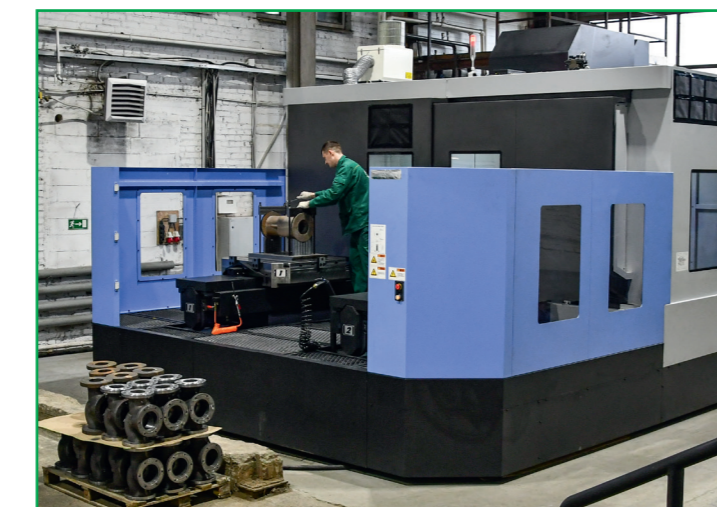
Двухпаллетный фрезерный станок с ЧПУ для обработки крупногабаритных деталей
